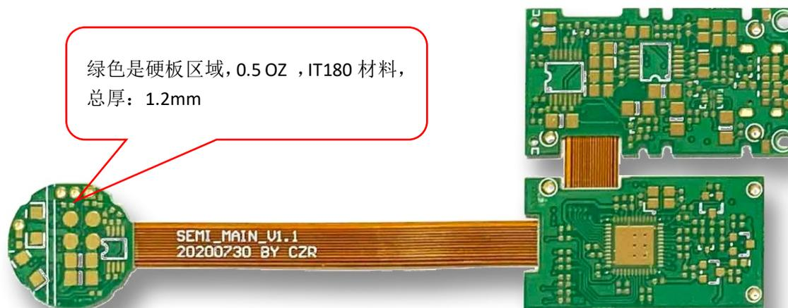
产品类别：4层刚柔结合板（结构：第1层硬板+第2、3层软板+第4层硬板）
